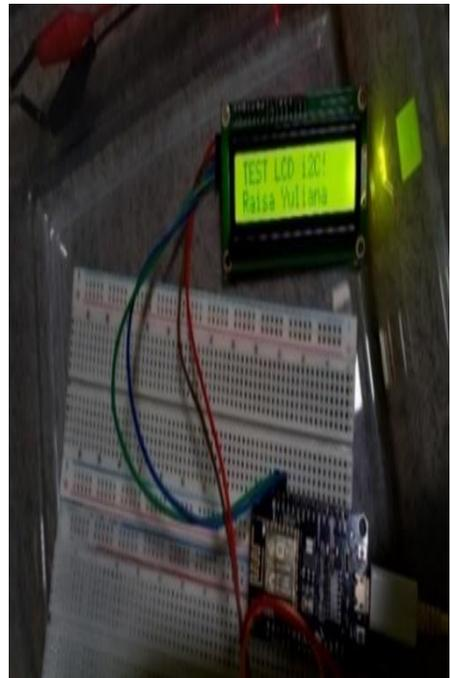
Gambar 5. Module LCD 16x2
