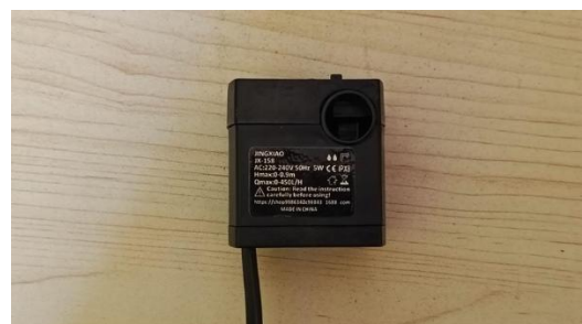
Gambar 5.14 Pompa air sebagai simulasi untuk mengalirkan air
