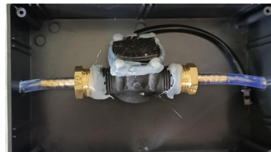
Gambar 5.13 Rangkaian yang menghubungkan sensor ke sumber air
