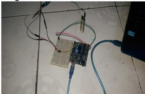
Gambar 5.2 Instalasi *module FC-28*
